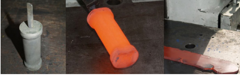
Bild 3.5.: Kapseln nach dem HIPen, während eines Zwischenschritts und im Endzustand beim Walzen
