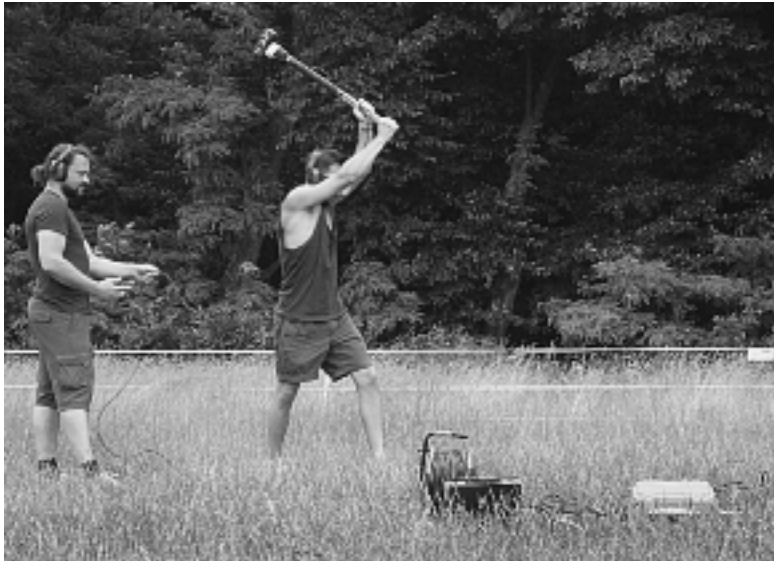
Abb. 2: Refraktionsseismik auf dem Segelflugplatz Rheinstetten
