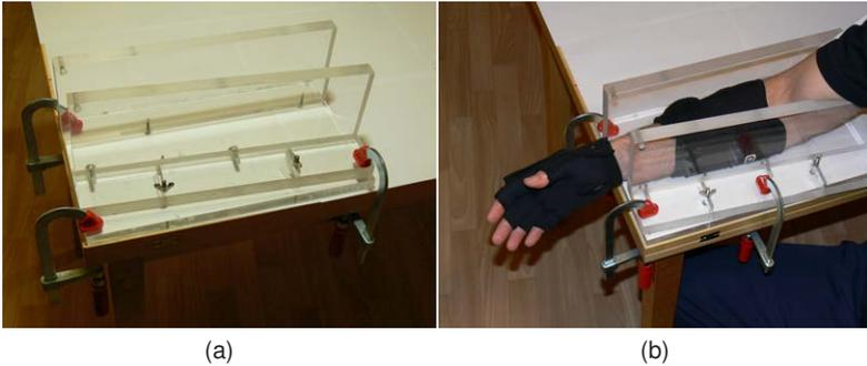
Bild 8.18: Einrichtung des entwickelten Unterarmhalters; (a) Befestigung des Unterarmhalters; (b) Unterarmhalter im Betrieb.
