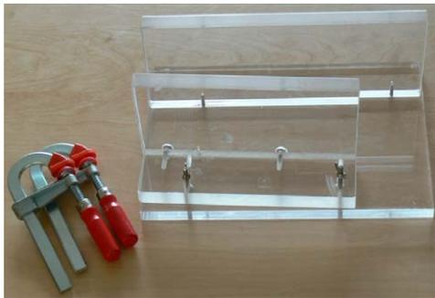
Bild 5.9: Unterlage zur Fixierung des Unterarms.
