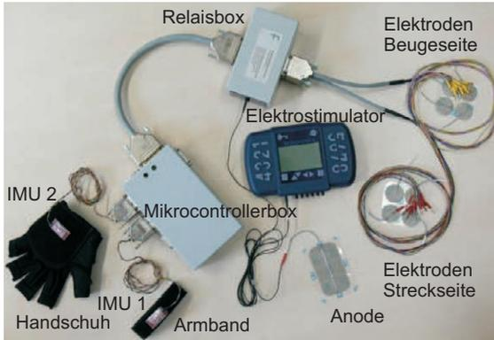
Bild 5.7: Neues Messsystem zum Auffinden der optimalen Position von Stimulations-
