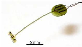
Bild 1.15: Eine tripolare Cuff-Elektrode zur Erfassung bioelektrischer Signale von Nervenfasern [109].
