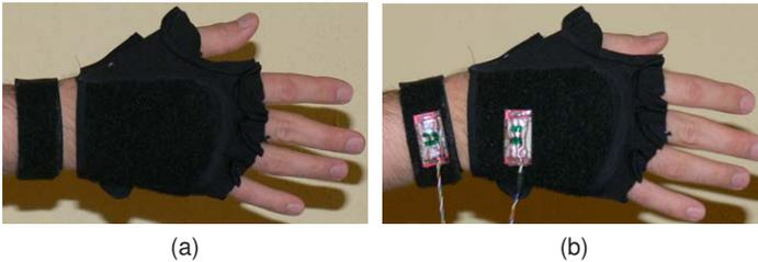
Bild 6.8: Handschuhe und Armband zur Positionierung der Inertialsensoren.
