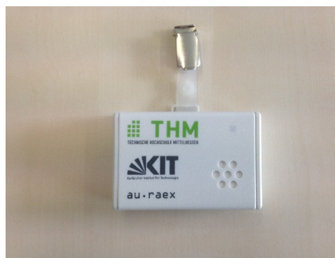
Abb. 5-6: automatisches Radonexposimeter au.raex
