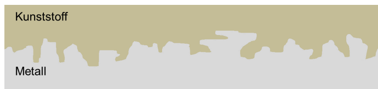
Abbildung 2.8: Prinzip der mechanischen Adhäsion an aufgerauter Oberfläche
