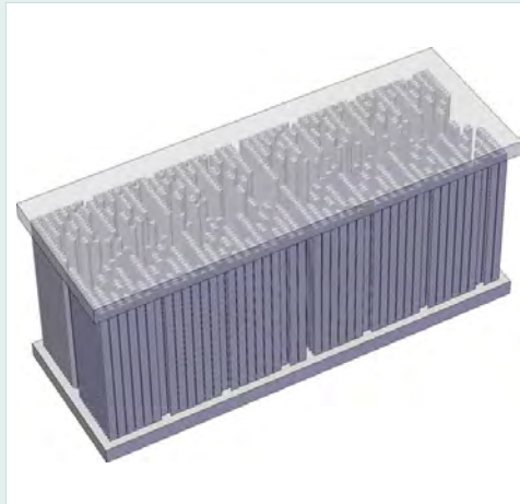
Refraktive Röntgenlinse mit Deck- und Bodenplatte.
