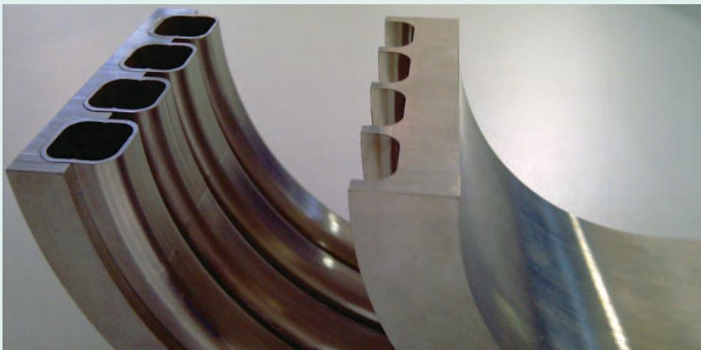
Sicheres Verschweißen von gekrümmten Bauteilen mit Hohlkörperstrukturen.
