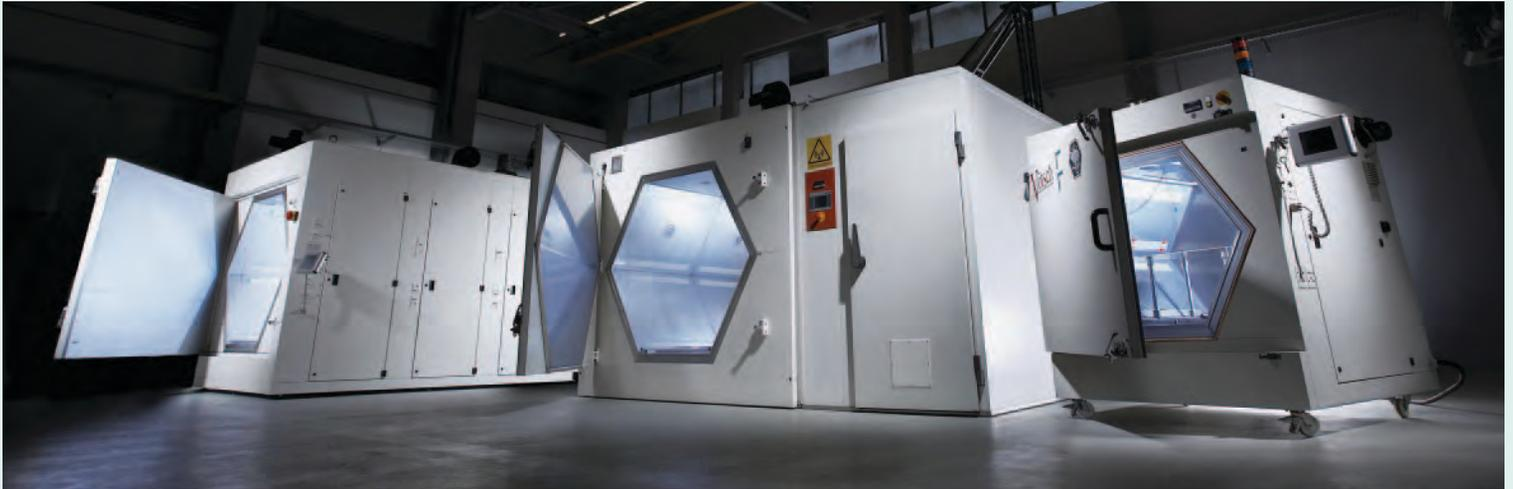
Modular aufgebaute Mikrowellenöfen mit hexagonaler Geometrie.
