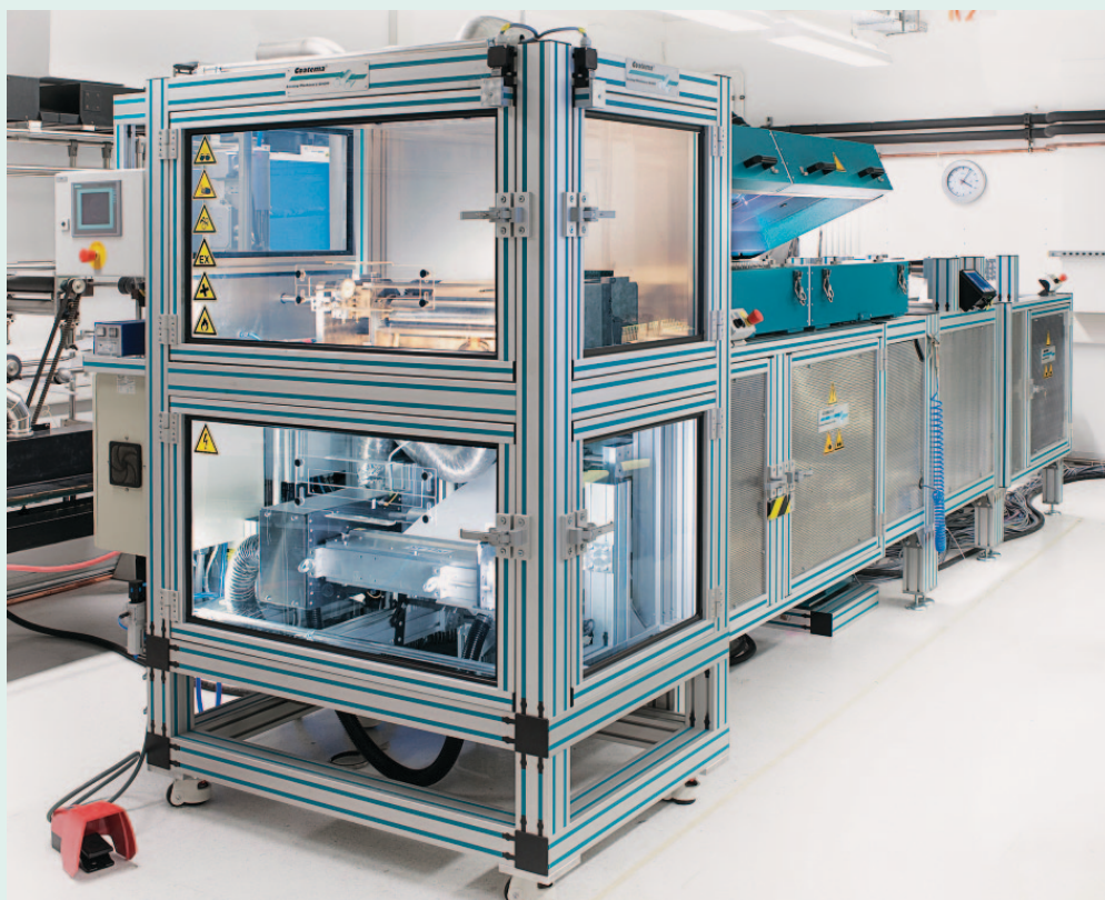
Schnellere und billigere Produktion durch Druckmaschinen: Der thermoelektrische Generator wird auf Folien gedruckt.
