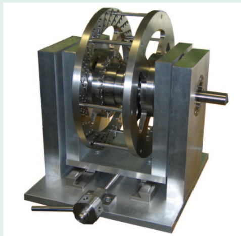
Die Entropiemaschine nutzt Entropieelastizität zur Energiegewinnung.
