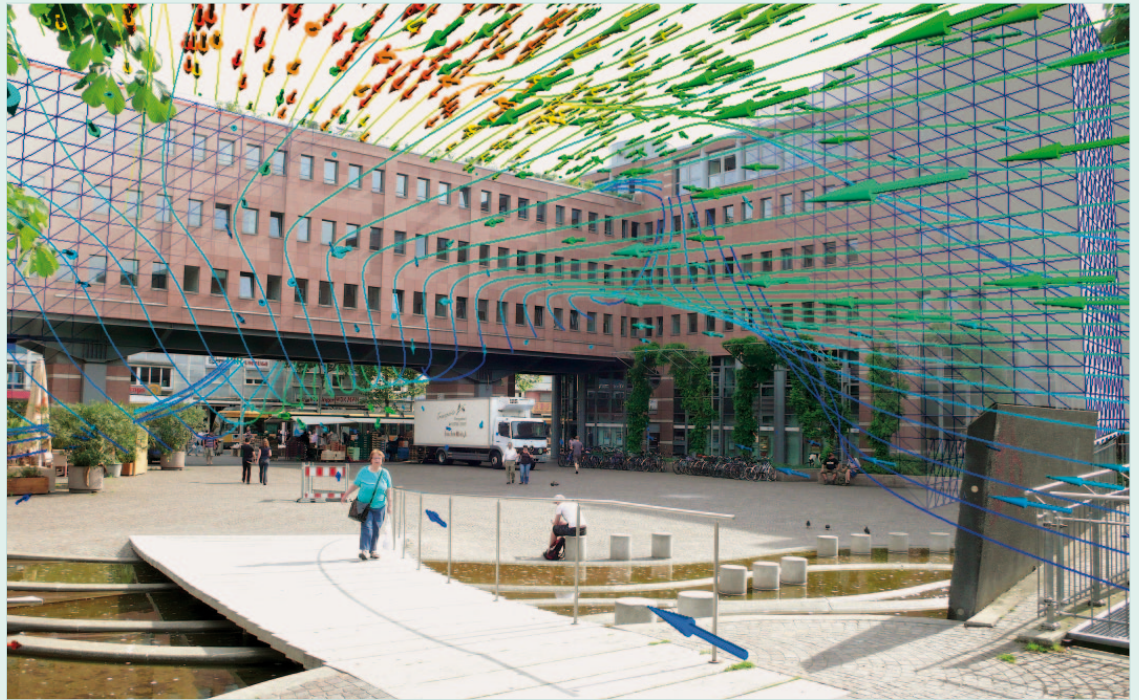
Windsimulation um das Gebäude der Fakultät für Mathematik am Karlsruher Kronenplatz auf Basis des Karlsruher Stadtmodells.
