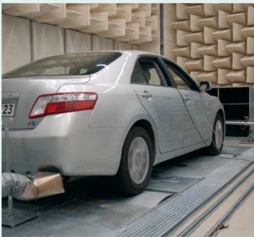
Fahrzeug auf dem Vehicle-in-the-Loop-Prüfstand am IPEK und in der Umweltsimulation.
