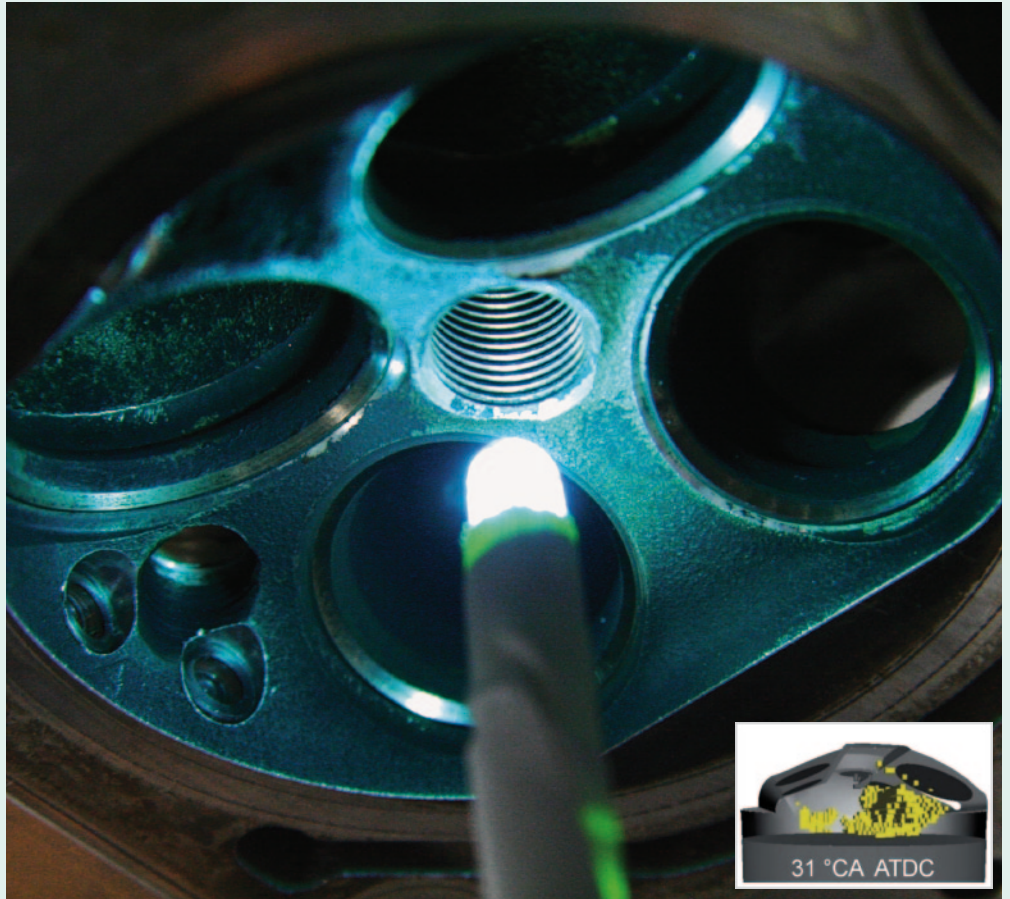
Endoskop im Motorraum (großes Bild), Darstellung der Flammen im Brennraum mit Tiefeninformationen (kleines Bild).
