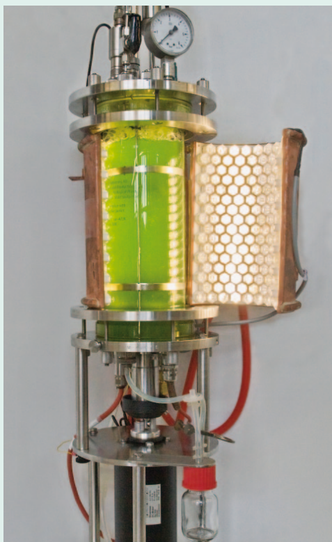
Beleuchtungsmantel an einem Photobioreaktor.
