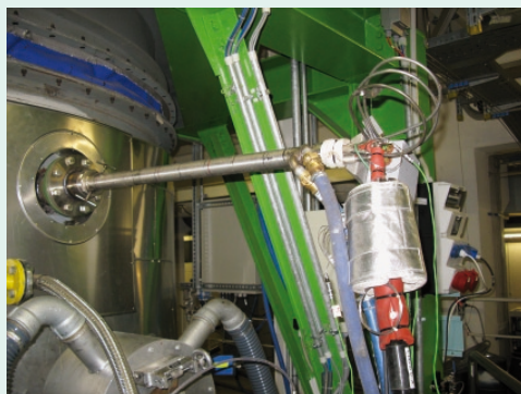
Gasbeprobungslanze im Laboreinsatz.
