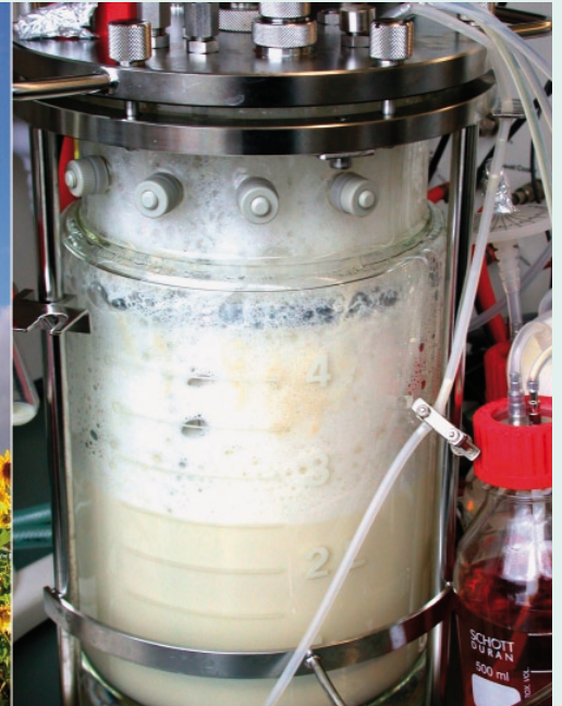
Regenerative statt fossile Rohstoffe: Durch Fermentierung von Sonnenblumenöl lassen sich mit Hilfe von speziellen Mikroorganismen Biotenside herstellen.
