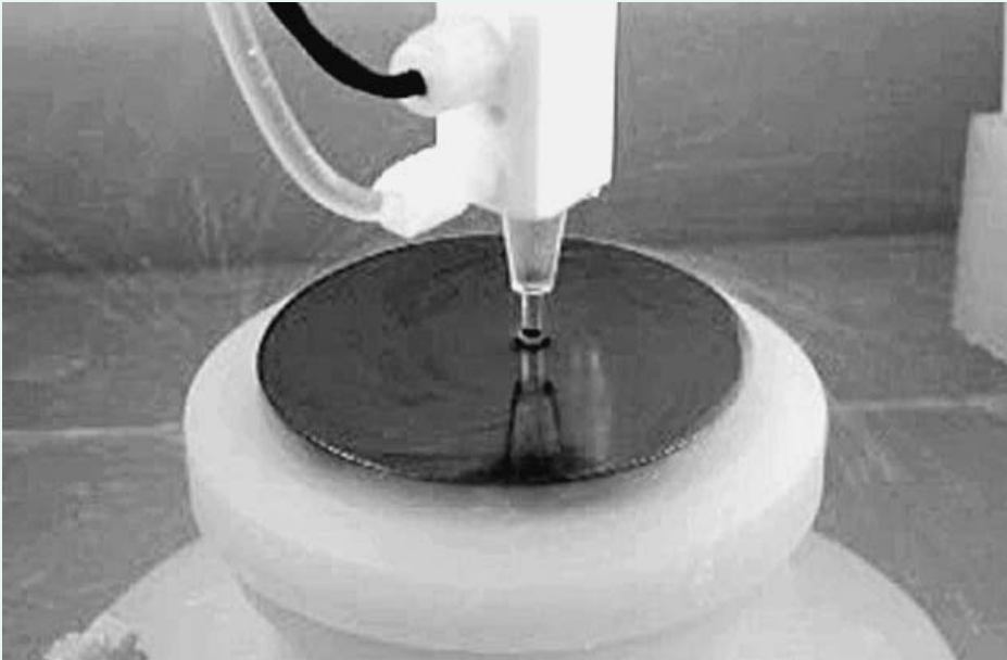
Die Megasonicsysteme der Firma Sonosys werden bei der nasschemischen Prozessierung von Halbleiter-Wafern (Foto), Substraten und Mikrosystemen eingesetzt.
