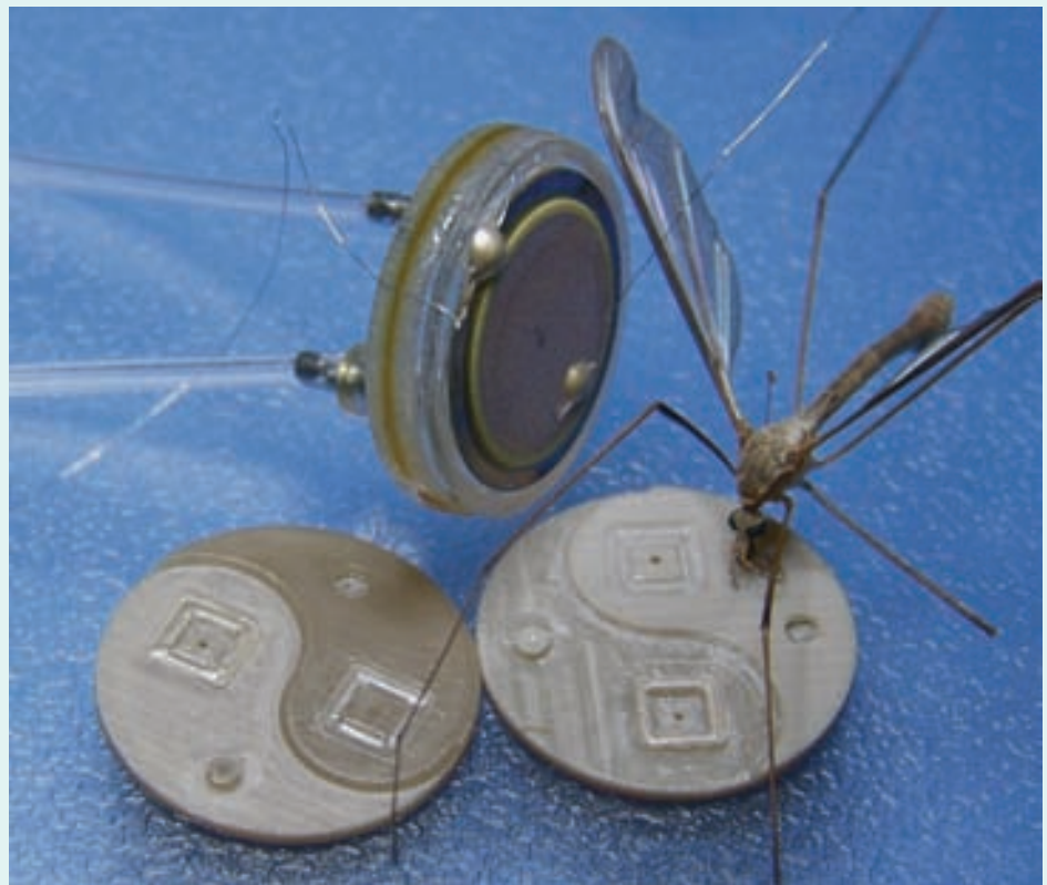
Mittels Ultraschallschweißen aufgebaute Piezomikropumpe mit einem Durchmesser von 14 Millimetern und einem Gewicht von 0,65 Gramm.
