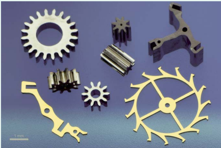
Das Institut für Mikrostrukturtechnik produziert Anker und Zahnräder aus unterschiedlichen Materialien
