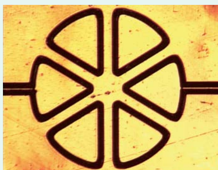
Funktionsschichten aus Nickel-Titan-Palladium lassen sich mit dem neuen Verfahren leichter ätzen
