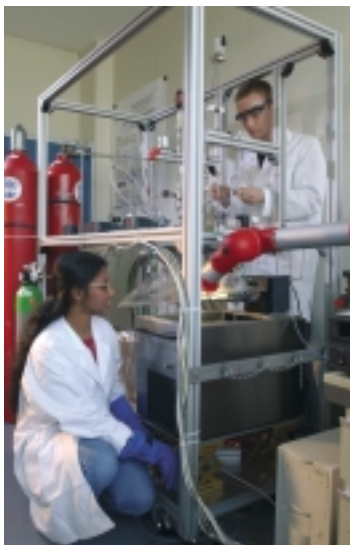
Anlage für die Untersuchung nanokristalliner Wasserstoffspeichermaterialien
