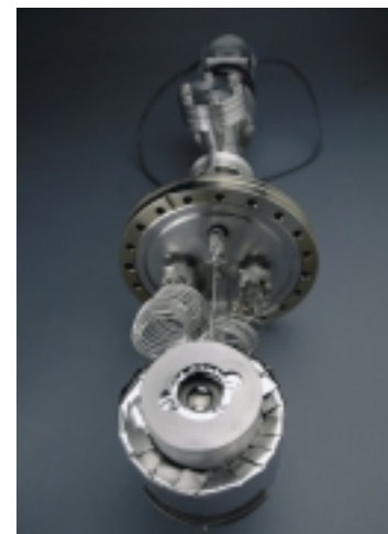
Ofen zur Erzeugung des Metaldampfes der leicht flüchtigen Komponente (unten) mit rotierbarem Substrathalter (oben), der von einer Strahlungsheizung umgeben ist. Die Einheit ist auf einem Standardflansch DN 160 CF montiert
