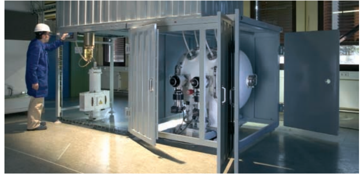
Die Anlage GESA-4 am Institut für Hochleistungsimpuls- und Mikrowellentechnik ist Basis für die Werkstoffentwicklung mit gepulsten Elektronenstrahlen
