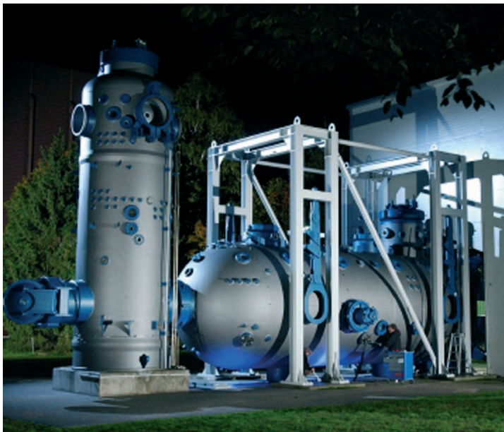
Außenansicht des neuen Wasserstoff-Versuchszentrums am Forschungszentrum Karlsruhe. Im Vordergrund die beiden großen Druckkammern für Freisetzungs- und Verbrennungsexperimente.
