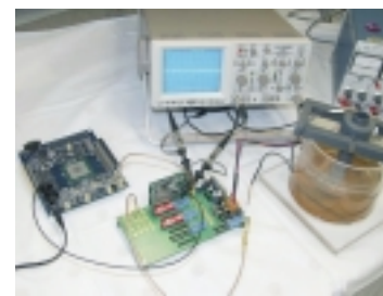
Demonstrationsaufbau des THE-Systems mit ebenfalls am IPE entwickelter Low-Noise-Verstärker-/Multiplexer-Einheit für Ultraschallwandler im NDT-Bereich
