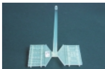
Abb. 2: Dünne PMMA-Plättchen, gefüllt mit nanoskaligen Keramikpulvern.
