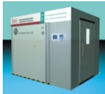
„Mikrowellenofen“ – diese neuartige Anlage vereinigt alle Fertigungsschritte von FVW-Strukturteilen über Mikrowellentechnik
