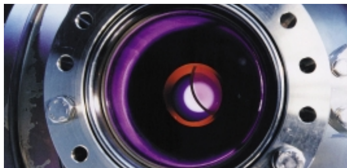
Blick in die ASIDOD-Sputterkammer mit einem 3-Zoll-Substrat, das vor dem Plasma der hinteren Sputterkathode rotiert
