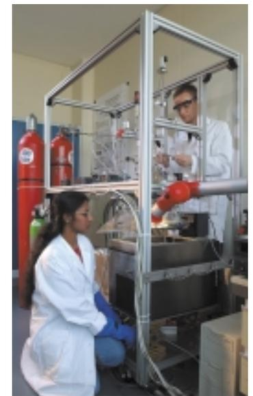
Laboranlage des INT zur Untersuchung der Wasserstoff-Speicher-Eigenschaften von Nanopartikeln
