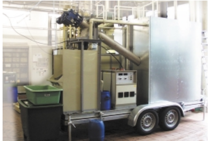
Mobile Elektroporationsanlage KEA zur Maischebehandlung.
