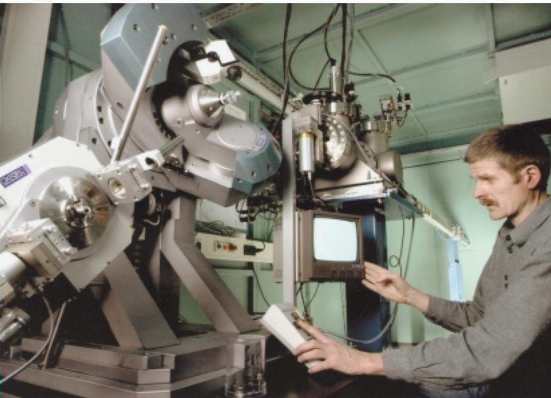
Mit kurzwelligen Röntgenstrahlen werden in einem so genannten Diffraktometer Kristalle und Pulver untersucht, um innere Strukturen und Kristallgrößen hochgenau zu vermessen
