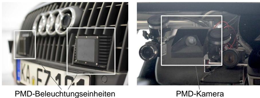
Bild 2.4: Tiefenbild-Kamera in Testfahrzeug „CoCar“: Das System besteht aus zwei Beleuchtungseinheiten im Kühlergrill und einer Kamera hinter der Windschutzscheibe.
