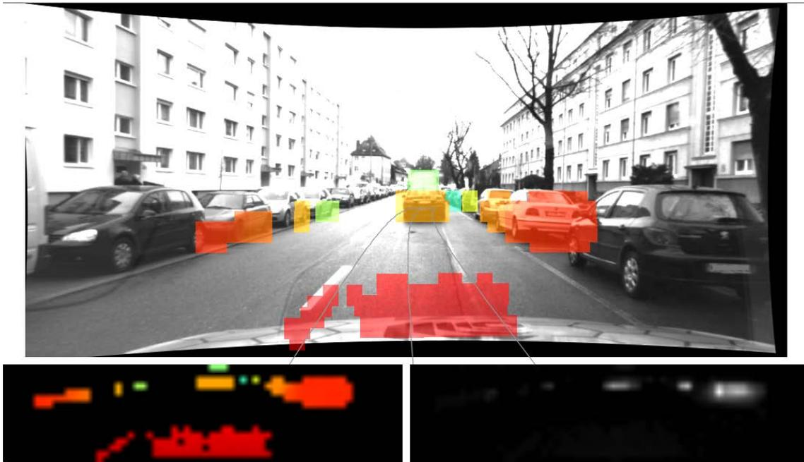
Bild 6.2: PMD- und Videodaten aus Sicht von „CoCar“; oben: Videodaten nach Linsenzerrung mit Überlagerung der PMD-Daten; unten links: Tiefendaten der PMD-Kamera in Falschfarbendarstellung; unten rechts: Amplitudendaten der PMD-Daten.
