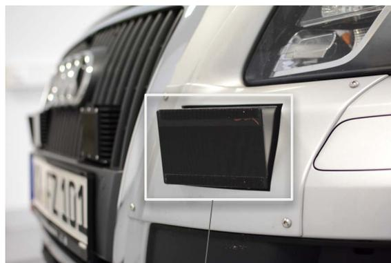
ibeo LUX Lidar-Sensor
