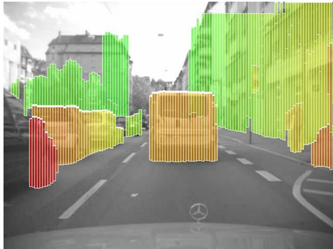
Bild 3.3: Stereodaten werden durch die Stixel-Repräsentation zu Stiften zusammengefasst, welche auf der freien Fahrfläche aufsetzen [PF10].
