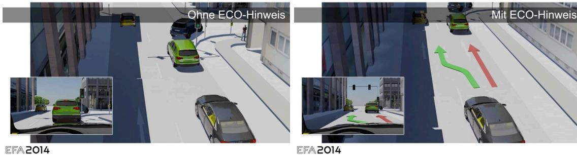
Bild 6.46: Im Projekt EFA2014 wurden mit Hilfe von Vorausschau-Informationen Spurwechsel-Hinweise für energieeffiziente Assistenz berechnet [Sch+12].
