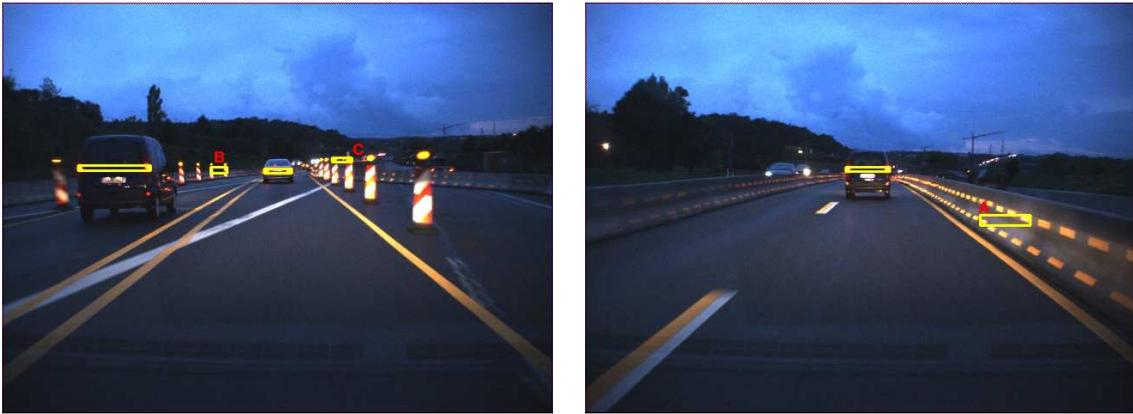
Bild 6.32: Fehler bei der Erkennung von Fahrzeughypothesen bei Nacht durch reflektierende Baustellenmarkierungen.
