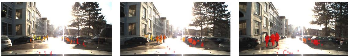
Bild 6.15: Messgüte der PMD-Sensorik bei direktem Sonnenlicht; die Messqualität ist durch das Sonnenlicht nicht beeinflusst.
