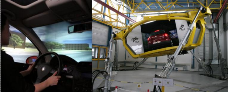
Abb. 4.14: Links: Das Cockpit. Rechts: Der dynamische Fahrsimulator des Deutschen Zentrums für Luft- und Raumfahrt. [49]
