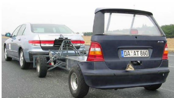
Abb. 2.15: Aufbau von EVITA: Zugfahrzeug und Anhänger (Dummy Target) [97]
