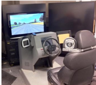
Abb. 5.19: Der statische Simulator von der Robert Bosch GmbH in Leonberg
