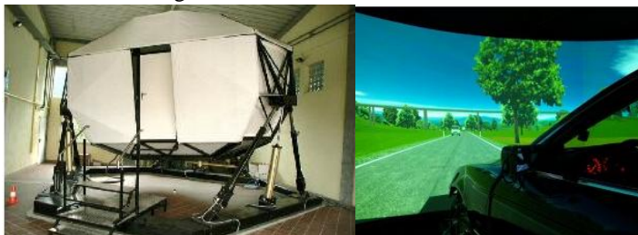
Abb. 5.27: Links: Der dynamische Fahrsimulator des WIVW. Rechts: Das Cockpit. [219]
