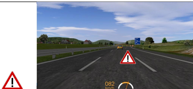
Abb. 5.15: Das Warndreieck: Links: das Warnelement; Rechts: die Anzeigeposition in der Simulationsumgebung [158]
