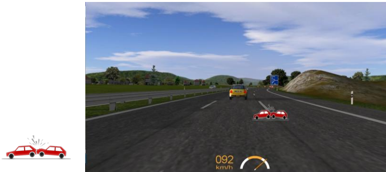
Abb. 5.18: Die Kollisionsanzeige: Links: das Warnelement; Rechts: die Anzeigeposition in der Simulationsumgebung [158]
