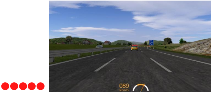
Abb. 5.16: Die Bremsleiste: Links: das Warnelement; Recht: die Anzeigeposition in der Simulationsumgebung [158]
