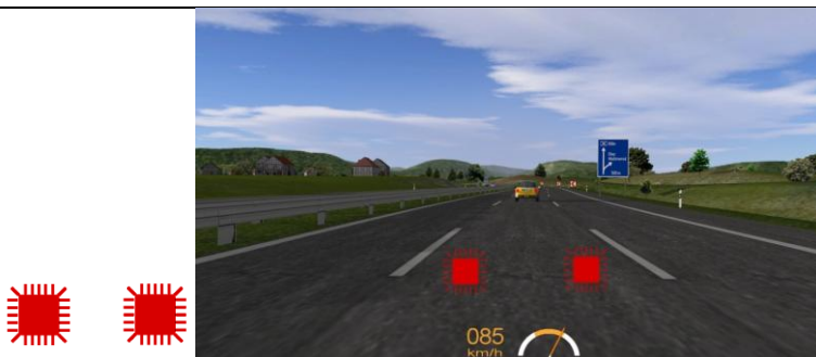
Abb. 5.17: Die Bremslichter: Links: das Warnelement; Rechts: die Anzeigeposition in der Simulationsumgebung [158]
