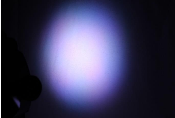
Abbildung 36 Foto der farblichen Abstrahlcharakteristik des LED-RGB- Scheinwerfers
