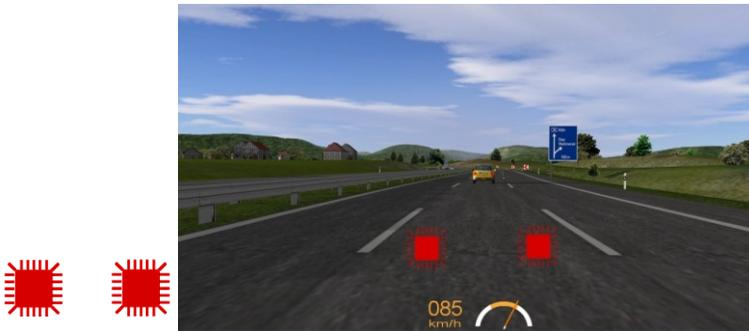
Abb. 5.17: Die Bremslichter: Links: das Warnelement; Rechts: die Anzeigeposition in der Simulationsumgebung [158]
