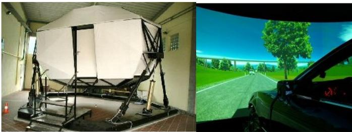
Abb. 5.27: Links: Der dynamische Fahrsimulator des WIVW. Rechts: Das Cockpit.
