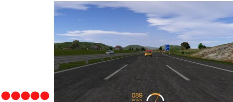
Abb. 5.16: Die Bremsleiste: Links: das Warnelement; Recht: die Anzeigeposition in der Simulationsumgebung [158]
