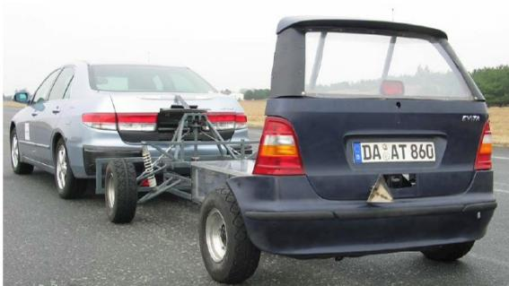
Abb. 2.15: Aufbau von EVITA: Zugfahrzeug und Anhänger (Dummy Target) [97]
