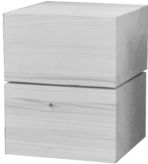
Abb. 3: Prüfkörper zur Relaxationsbestimmung. Maße b/b/h = 160/160/200 mm
