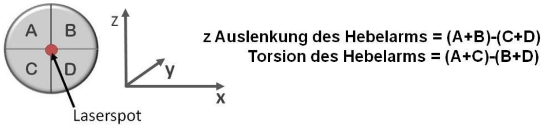
Abbildung 27 Einteilung der 4-Quadranten-Photodiode zur Bestimmung der Auslenkung des Cantilevers, in Abhängigkeit von den Wechselwirkungen zwischen Spitze und Probenoberfläche.
