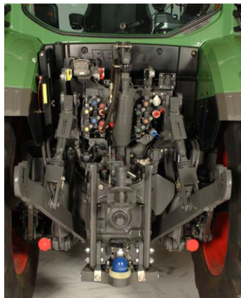
Abb. 2.8: Schnittstellen im Traktorheck
