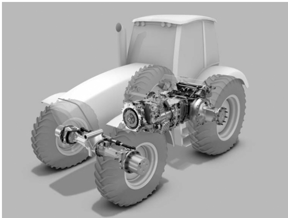
Abb. 2.9: Traktorgetriebetechnik beinhaltet das eigentliche Getriebe, die Hinterachse und die angetriebene Vorderachse
