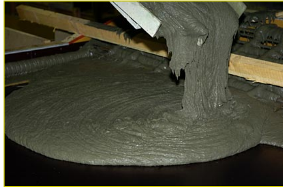
Abb. 9: Guss eines ultra-hochfesten Betons für die Gärtnerplatzbrücke in Kassel (Copyright: Fa. ELO Elementwerke Osthessen, Entwicklung: Universität Kassel)
