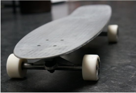
Abb. 10: Longboard aus hochfestem selbstverdichtendem Beton
