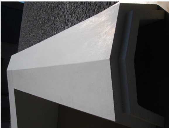
Abb. 23: Fassadenelemente aus Ultra-hochleistungsbeton für das Hochhaus Upper West in Berlin, oben Spannungsrechnungen, unten Musterelement mit einer Elementdicke von 25mm (Copyright: Fa. Züblin AG, Fertigteilwerk Gladbeck)
