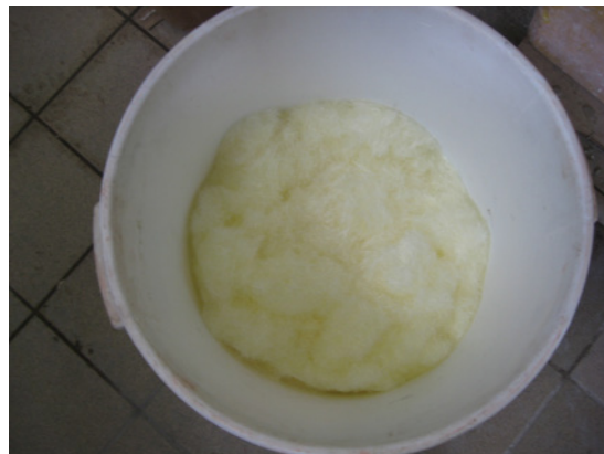
Abb. 10: Glasfasern als „Bewehrung“ für einen ultra-hochfesten Beton eines Fassadenelementes (Copyright: Fa. Lafarge, Foto: Bachmann, Ed. Züblin AG)
