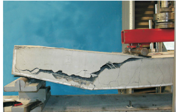
Abb. 12: Fahrbahnplatte (Vier-Punkt-Biegeversuch): Versagenszustand
