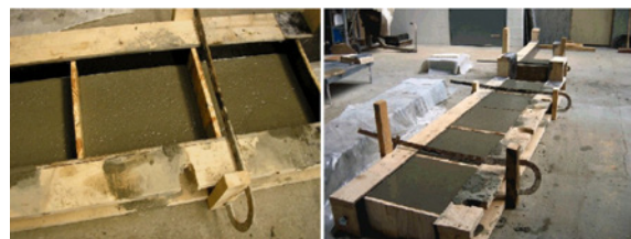
Abb. 26: Versuchsaufbau zur Betonage von Platten in 2 Schüttilagen [15]
