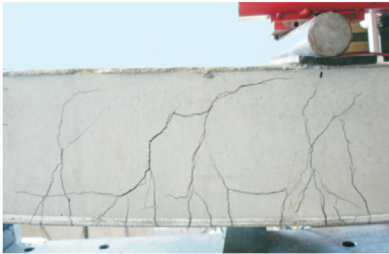
Abb. 11: Fahrbahnplatte (Vier-Punkt-Biegeversuch): Rissbild
