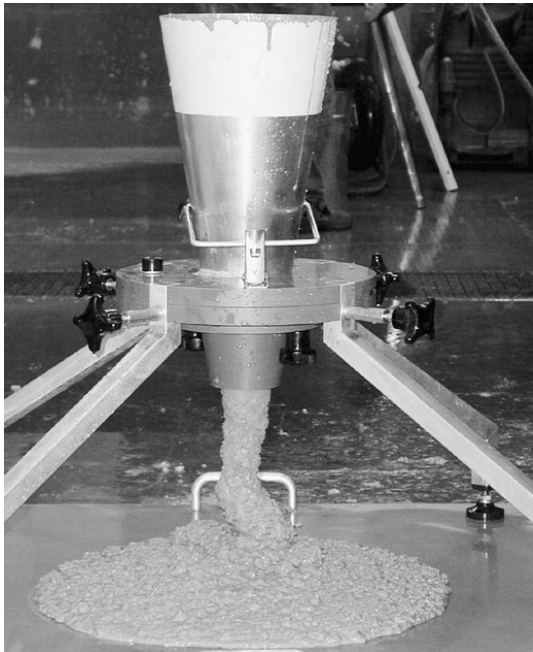
Abb. 3: Auslaufkegel für selbstverdichtenden Beton zur Prüfung der Auslaufzeit und des Setzfließmaßes [15]
