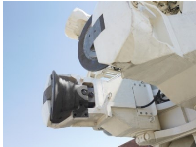
Abbildung 2.4: Aker Wirth Mobile Tunnel Miner mit Hinterschneidtechnologie [29]
