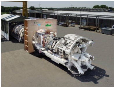
Abbildung 2.4: Aker Wirth Mobile Tunnel Miner mit Hinterschneidtechnologie [29]
