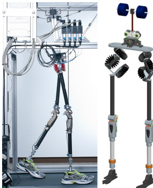
Abb. 4.5.: Versuchsaufbau zur experimentellen Erprobung (links) und ganzheitliches pneumatisches Konzept für die zukünftige zweite Generation (rechts) [145]
