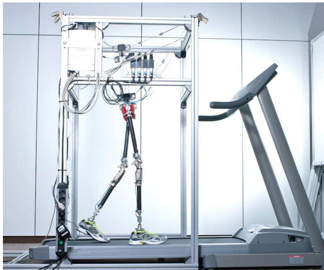
Abb. 4.1.: Versuchsaufbau: Zweibeiniger semi-passiver, pneumatisch angetriebener Demonstrator auf Laufband am IAI des KIT
