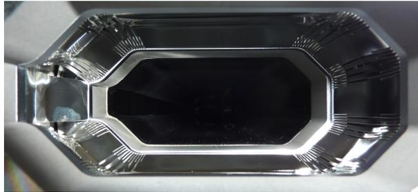
**Abbildung 4.3:** HF-Abschirmung der Kontaktstelle zweier Vakuumkammerflansche sorgt für kontinuierliche Randbedingungen und reduziert Energieverluste durch Impedanz.
