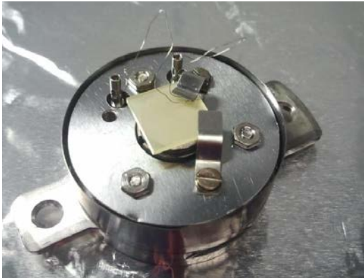
Abbildung 42: Zinkoxid ( 10\bar{1}0 )-Einkristall auf einem Probenhalter mit Elektronenstoßheizung. Der Kristall ist mit Tantalclammern, das Thermoelement auf dem Kristall unter einer Klammer befestigt.
