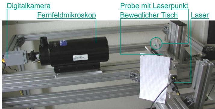
Abbildung 5.8: Versuchsaufbau zur Entwicklung eines optischen Verfahrens zur Messung der Eindringtiefe
