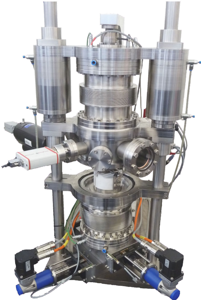
Abbildung 5.27: Karlsruher Hoch-Temperatur-Indentationsanlage KAHTI
