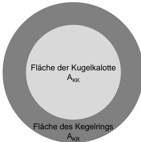
Abbildung B.1: Anteil der Flächenfunktionen von Kugel und Kegel bei der Indentation mit einem Rockwell-Kegel
