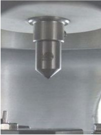
(a) Standard-Rockwell Eindringkörper zur Entwicklung der Prüfvorschrift
