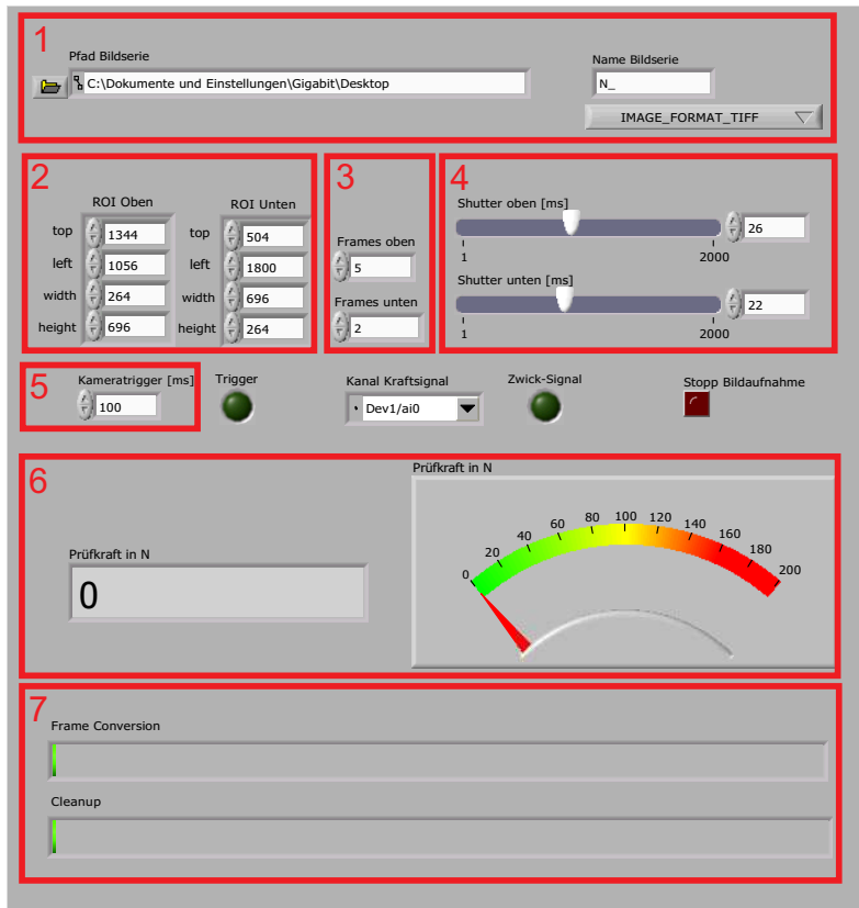
Abbildung C.12: Bedienoberfläche des virtuellen Instruments „KAHTeye“ zur Steuerung und Bildaufnahme des optischen Systems. 1 — Angaben zum Speicherort und Zielformat, 2 — Angabe der Bildausschnitte, 3 — Angabe der Bildanzahl je Schleife, 4 — Angabe der Belichtungszeiten, 5 — Angabe der Aufnahmerate, 6 — Anzeige der Prüfkraft, 7 — Fortschrittsbalken zur Umwandlung der Bilddaten.
