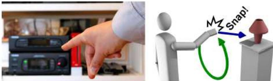
Abb. 32. Konzept des Systems aus [65]: Die Auswahl erfolgt per Zeigegeste, die Bestätigung per Geräusch
