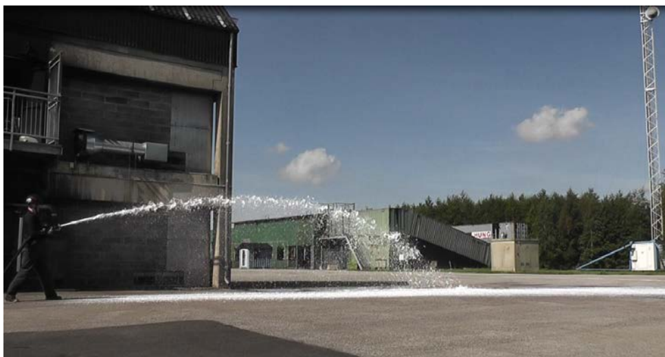
Abbildung 10: Wurfweite des ausgebildeten stationären Löschmittelstrahles bei nassem Druckluftschaum [Lyckeback und Öhrn /2012/, /63/]
