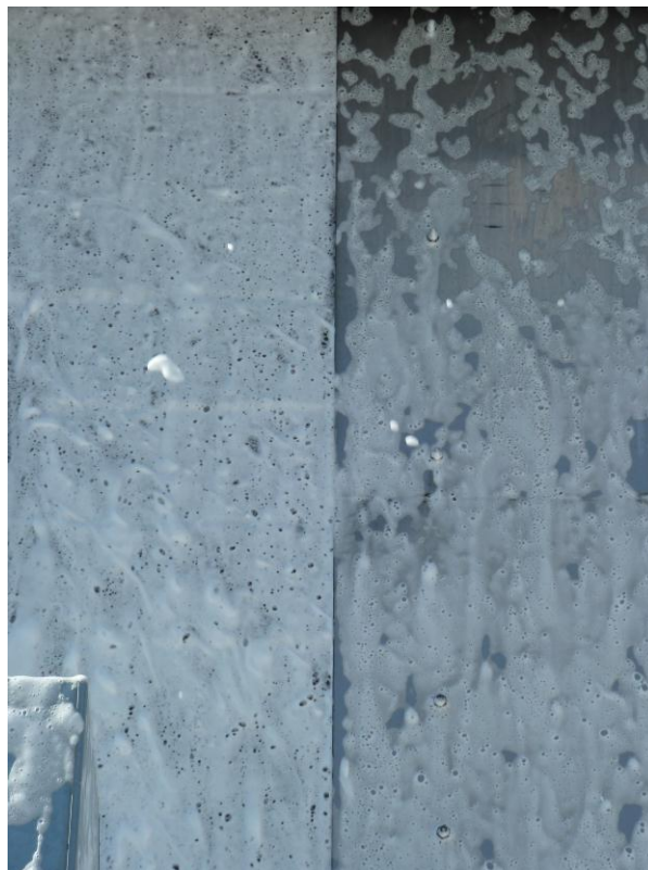
Abbildung 12: Beaufschlagung mit Druckluftschäum: Bild links: Nasser Schaum auf rauher Oberfläche, Bild rechts: auf glatter Oberfläche ein paar Minuten nach der Beaufschlagung [Lyckeback und Öhrn /2012/, /63/]
