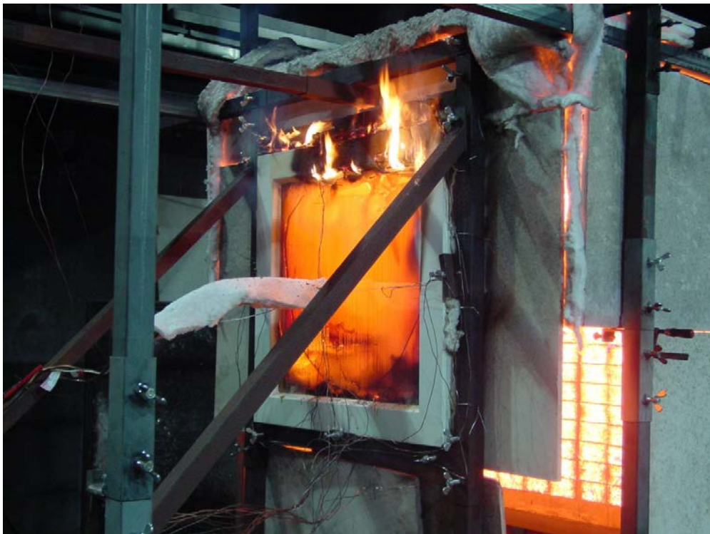
Abbildung 6: Versuchseinrichtung zur Untersuchung von unterschiedlichen Fenstern mit realitätsnaher thermischer Belastung [Kunkelmann /2013/, /10/].
