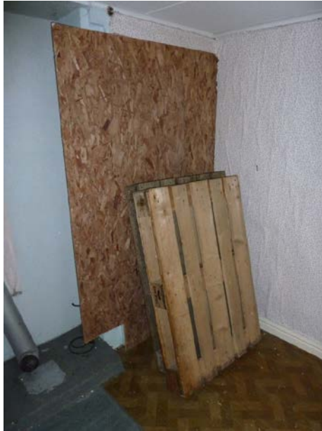
Abbildung 15: Brandlast in den Räumen (2 Holzplatten, Zündquelle: 1 l Flüssig-Grillanzünder) [Lyckeback und Öhrn /2012/, /63/]
