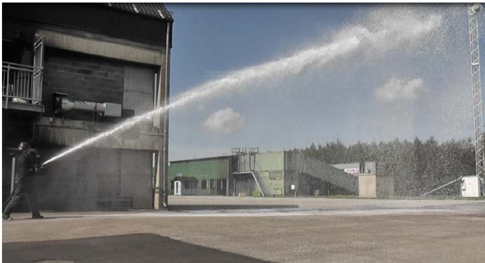
Abbildung 9: Wurfweitenerhöhung des Löschmittelstrahles beim Öffnen des Strahlrohres bei nassem Druckluftschaum [Lyckeback und Öhrn /2012/, /63/]
