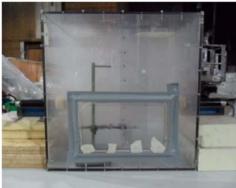
Abbildung 25: Foto zum Versuchsaufbau zur Messung der Nebelstandzeit
