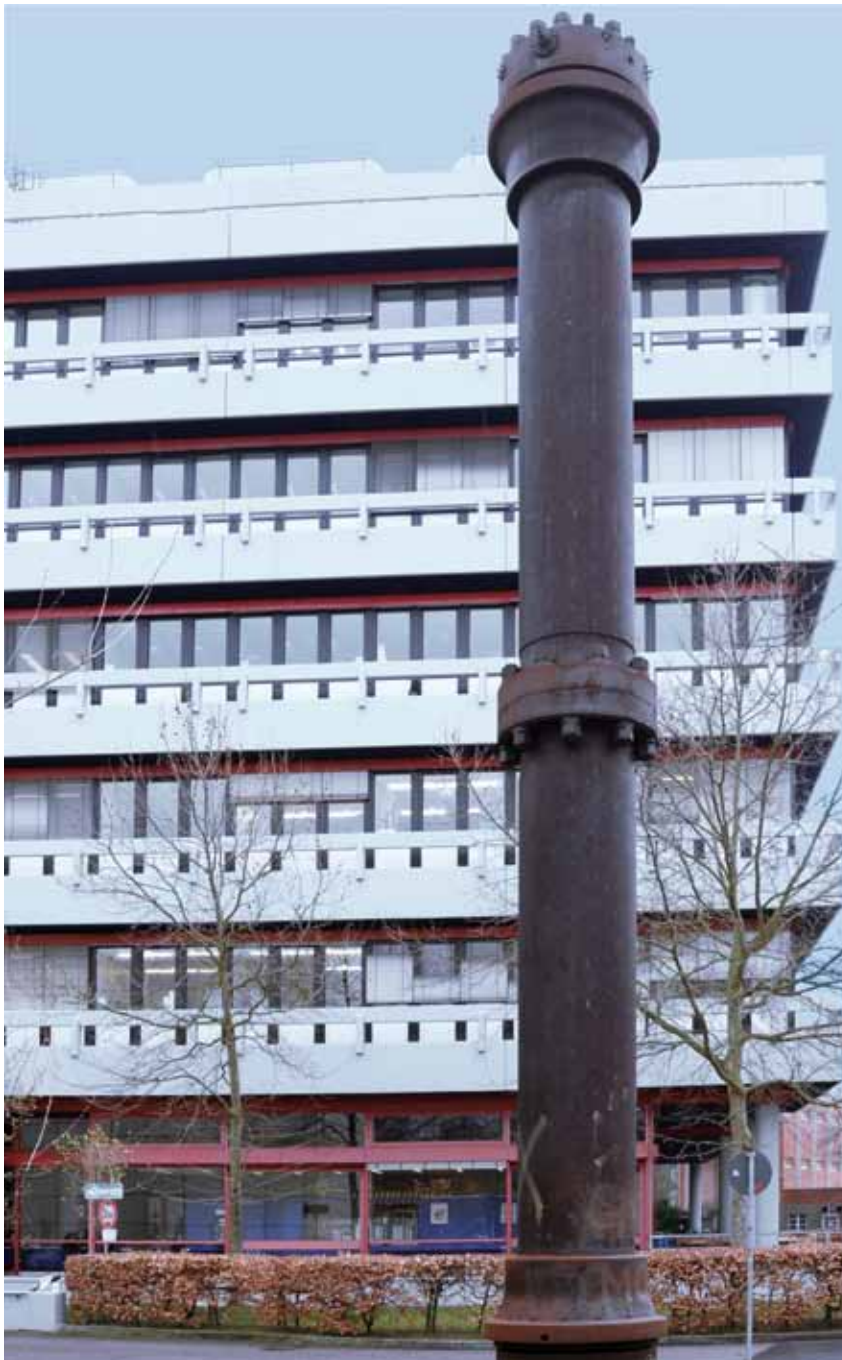
War von 1923 bis 1982 in Betrieb: der Hochdruck-Reaktor zur Ammoniak-Synthese auf dem Campus Süd, Engesserstraße/ Ecke Fritz-Haber-Weg
