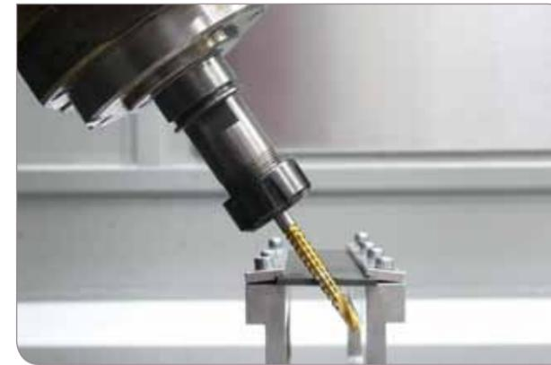
Spanende Bearbeitung faserverstärkter Kunststoffe, Institut für Produktionstechnik
