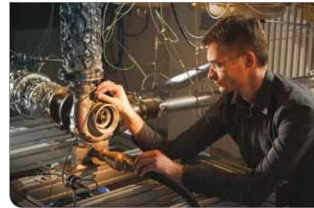
Prüfstand zur Untersuchung von Turboladern mit ein- und mehrflüchtigen Turbinen, Institut für Thermische Strömungsmaschinen
