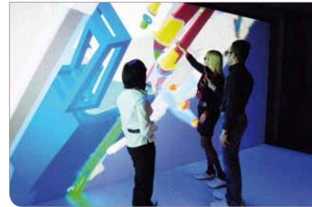
Virtuelle Prototypen im LESC: Immer mehr Unternehmen setzen auf interaktive Absicherung in virtuellen Umgebungen, in die die Nutzer vollständig integriert sind. Institut für Informationsmanagement im Ingenieurwesen
