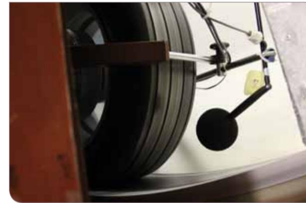
Hörtest: Am Reifenprüfstand wird das Reifen-Fahrbahn-Geräusch untersucht, Institut für Fahrzeugsystemtechnik
