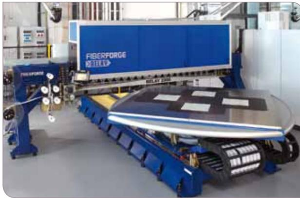
Leichtbau: Fiberforge Relay Station – Programmierbares Tape-Lege-system zum automatischen Zuschneiden und Laminieren flacher mehr-lagiger Vorformlingen unidirektional verstärkter thermoplastischer Tapes, Fraunhofer Institut für Chemische Technologie Pfnztal
