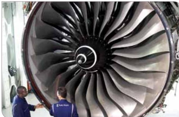
Das Trent XWB Triebwerk für den neuen Airbus A 350, Institut für Thermische Strömungsmaschinen, Foto: Rolls-Royce plc
