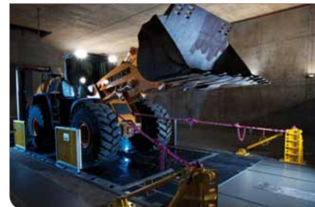
Radlager auf dem Akustikallradrollenprüfstand des Instituts für Fahrzeugsystemtechnik am KIT Campus Ost
