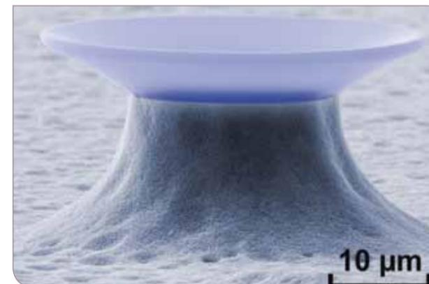
Rasterelektronenmikroskopische Aufnahme eines Mikrokelch-Resonators. Der neuartige photonische Mikroresonator aus Polymer kann für den hochsensitiven Nachweis von biologischen Inhaltsstoffen in flüssigen Medien verwendet werden. Er entstand in der inter-fakultativen Kooperation zwischen dem Institut für Angewandte Physik (AG Kalt) und dem Institut für Mikrostrukturtechnik (AG Mappes).
