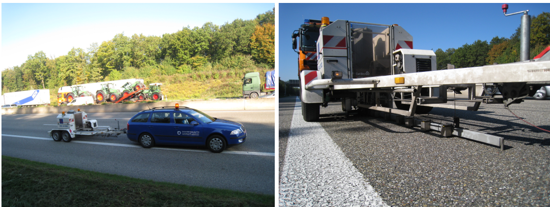
Abb. B.1: HWD mit Zugfahrzeug im Messbetrieb
