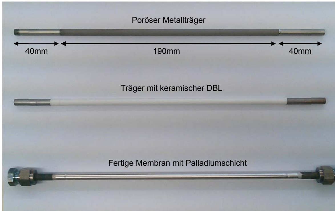
Abbildung 17: Aufbau der Pd-Kompositmembranrohre für den Labormaßstab
