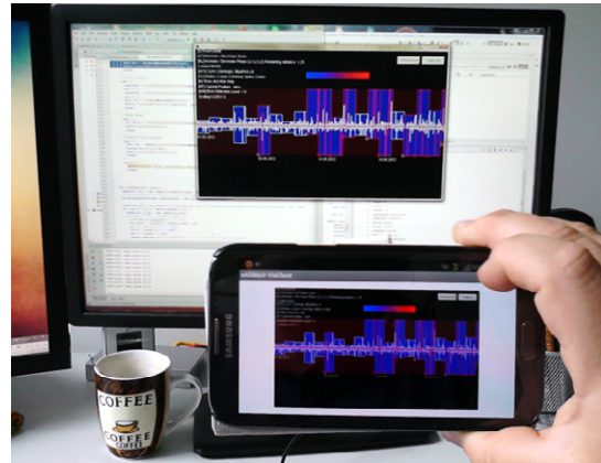
Abb. 59: Client-Server basierter Fernzugriff und Ferninteraktion mit EDR-Daten.
