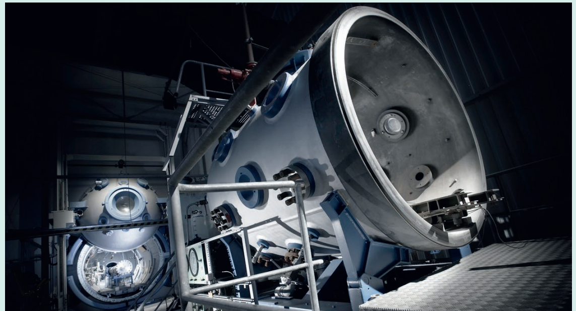
Im Wasserstoff-Versuchszentrum können Ergebnisse der Simulationen mit GASFLOW und COM3D experimentell überprüft werden.
