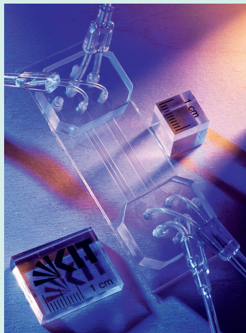
Das am KIT entwickelte mikrofluidische System aus dem biokompatiblen Kunststoff Polycarbonat erlaubt die In-vitro-Simulation von Abläufen in kleinsten Blutgefäßen.
