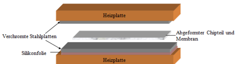
Abbildung 3.51: Darstellung des modifizierten Bondprozesses. Die obere Heizplatte ist fest und nur die untere ist beweglich.
